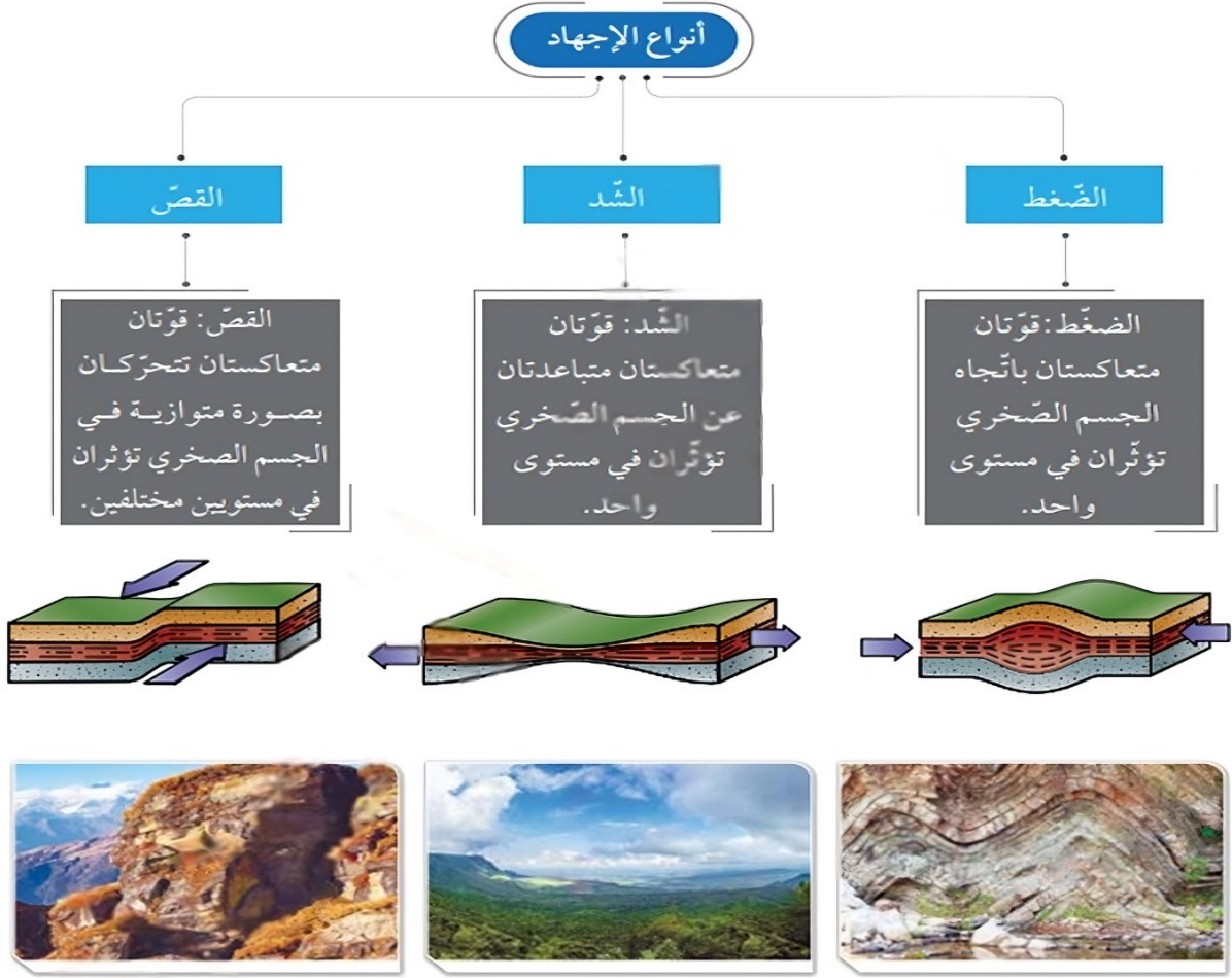
الشكل (5): أنواع الإجهاد. أقارن بين إجهاد الضّغط، وإجهاد القصّ من حيث اتجاه القوة المؤثرة في الصّخور.
